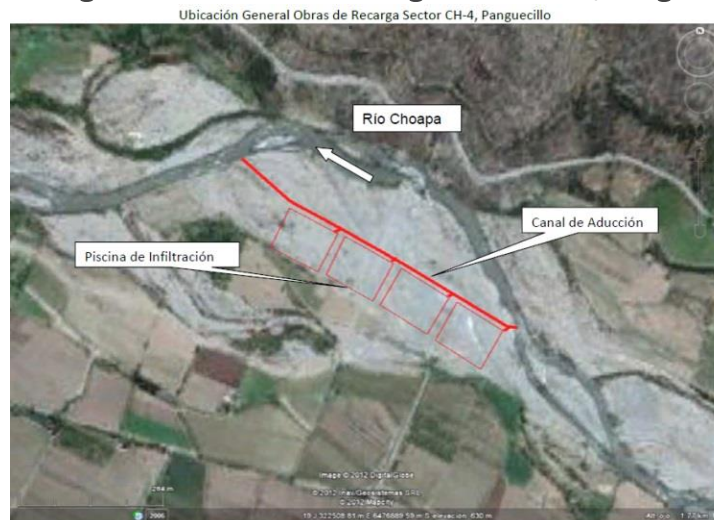
Figura 21 Ubicación general de Obras de Recarga Sector CH-4, Panguecillo
