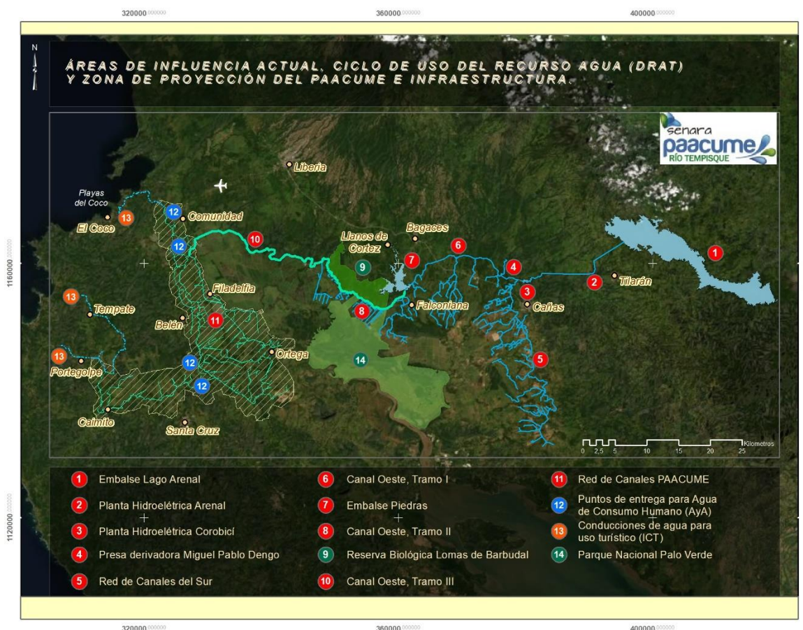
Ilustración 4 1. Esquema del proyecto Paacume desde la PMPD hasta la red de distribución en la margen derecha del río Tempisque
